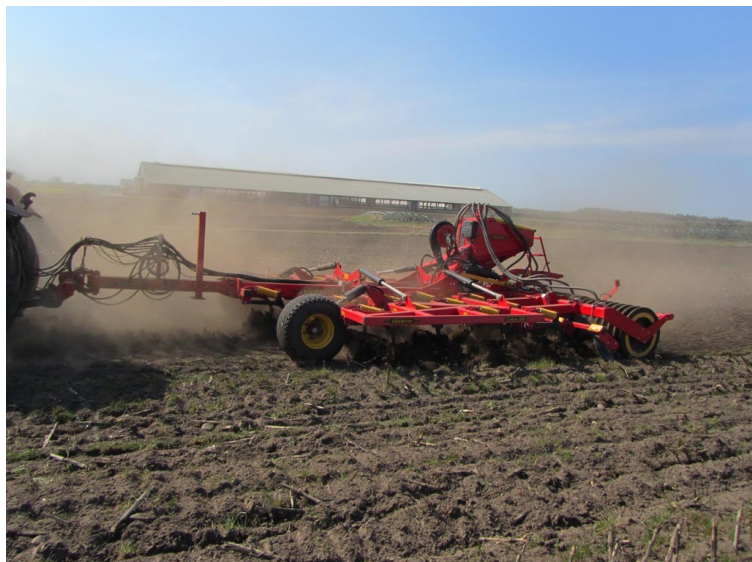
Billede 3. Väderstad Cultus er en stivtandet harve med en lille tandsporsafstand på 20 cm, der kan bearbejde i op til 30 cm dybde. Harven er monteret med en svær 80 cm gummipakvalse. Foto: Henning Sjørsløv Lyngvig, Videncentret for Landbrug.
