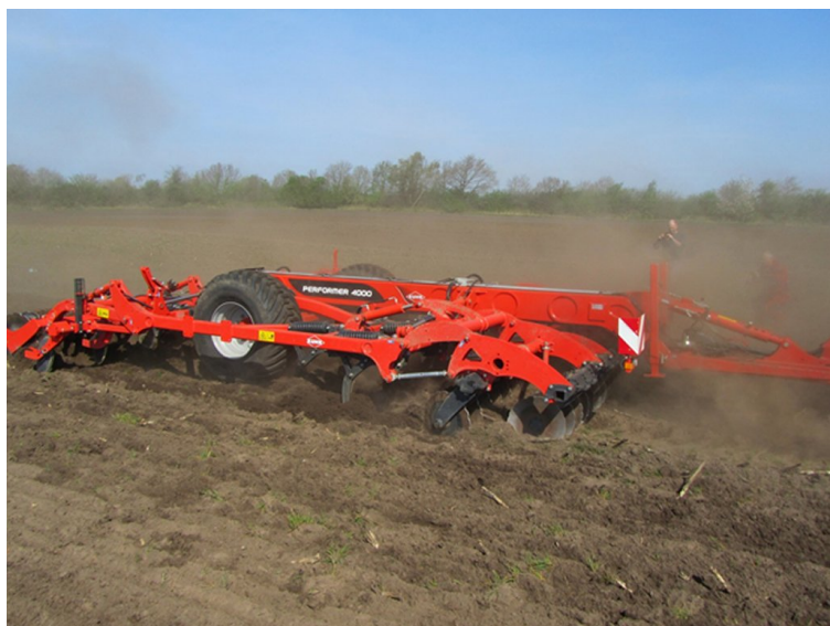
Billede 4. Kuhn Performer er en stivtandet harve med en tallerkensektion forrest. Harven har en tandsporsafstand på 28 cm og kan bearbejde i op til 35 cm dybde. Harven er monteret med en svær 70 cm HD-liner pakvalse. Foto: Henning Sjørsløv Lyngvig, Videncentret for Landbrug.
